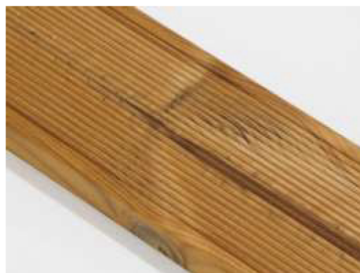
Malé podélné trhliny na povrchu jsou povoleny.
