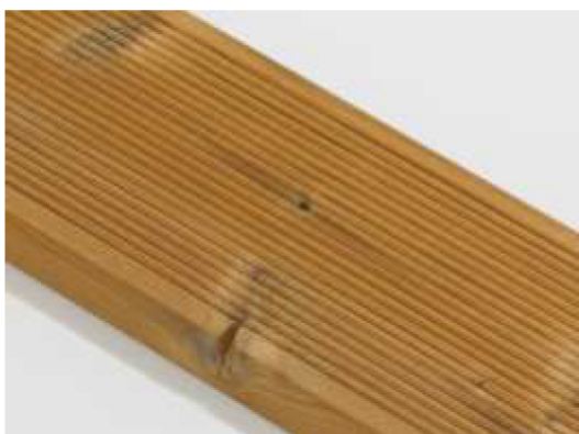
Malá prasklina suku na hraně je povolena.
